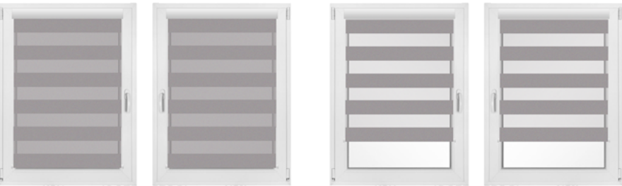
WARIANT B – różne ułożenie pasów w roletach o różnej długości przy pozycji opuszczonej (to samo zaciemnienie).
